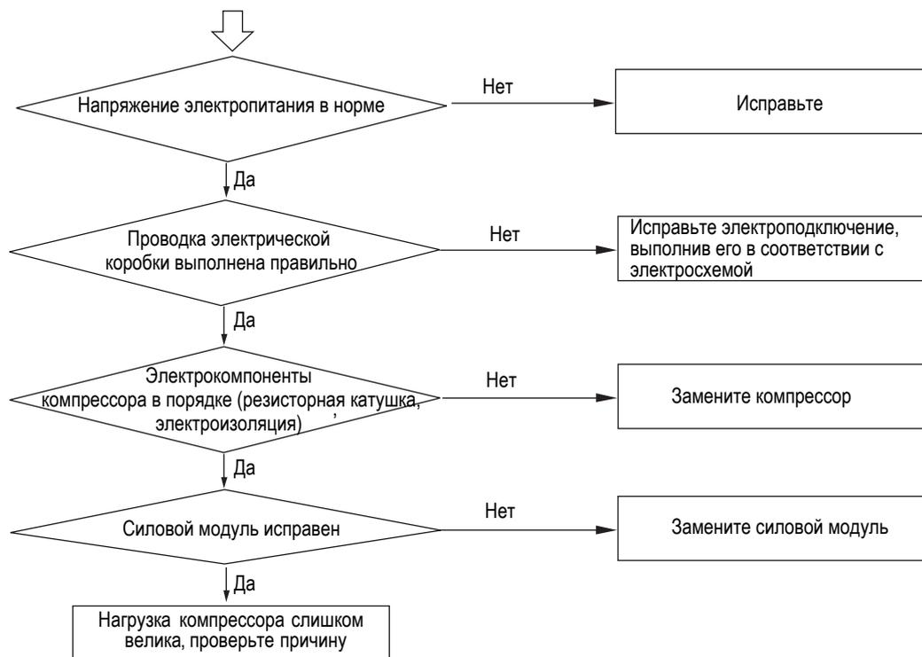
[114] слишком низкое напряжение силового контура DC-шины преобразователя
