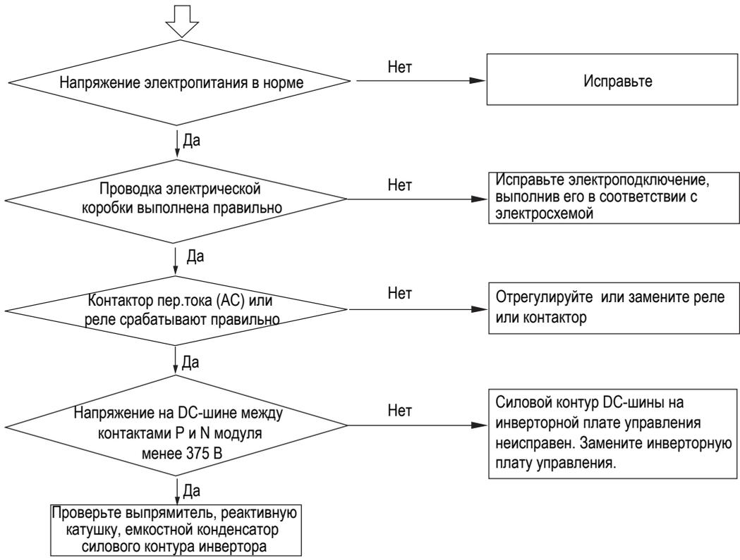
[115] слишком высокое напряжение силового контура DC-шины преобразователя
